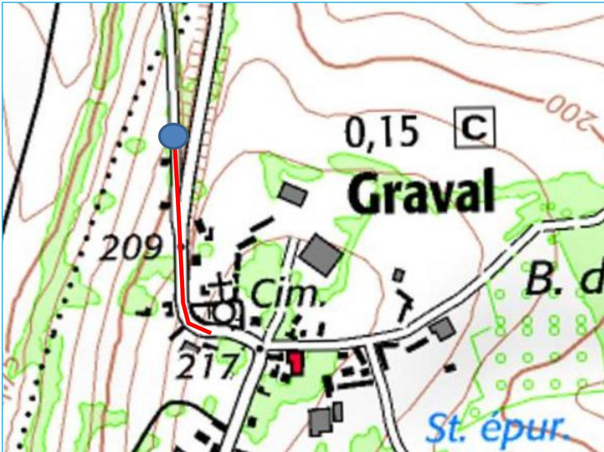
La topographie de la zone de collecte est défavorable ; le transfert vers le village imposera la mise en œuvre d'un poste de refoulement.
